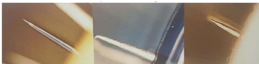
Figura 14: Três diferentes marcas de produto em aumento de 100x demonstrando a diferença na qualidade das microagulhas. Fonte: Lima (2017).
