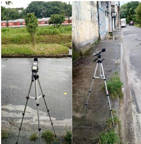
Figura 8: Posição de medição dos pontos P1, P2, P3, P4, P5 e P6 com medidor apontado para o emissor de ruído (esquerda) e vista da parte do entorno local do ponto de medição (direita).
