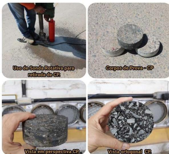
Figura 6: corpos de prova retirados em pista e avaliados em laboratório.
