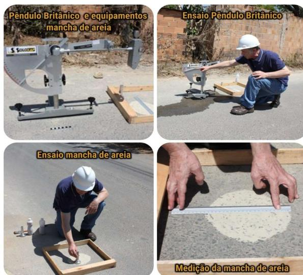
Figura 7: Ensaios para determinação da micro e macrotextura.
