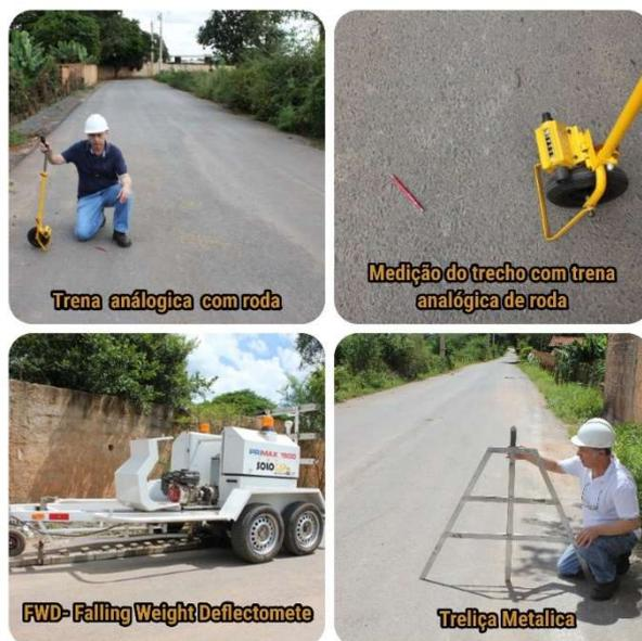
Figura 5: Equipamentos utilizados na fase de avaliação objetiva, funcional e estrutural (não destrutiva).
