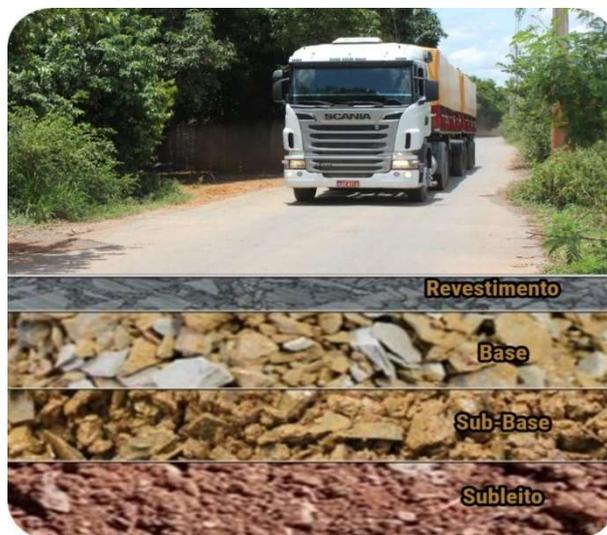
Figura 4: Perfil do pavimento em estudo.
