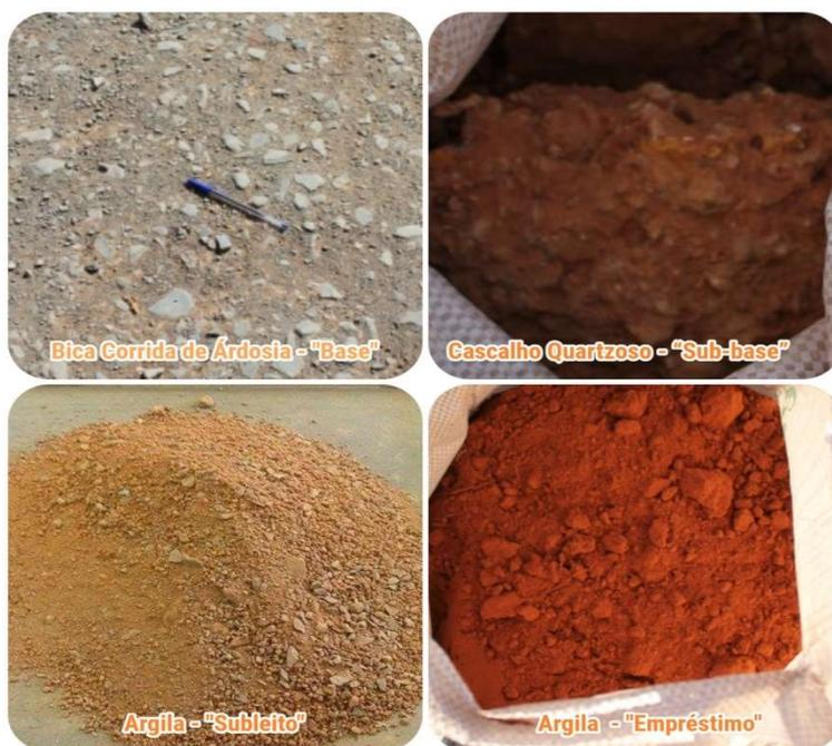
Figura 3: Solos utilizados nas camadas granulares do pavimento.
