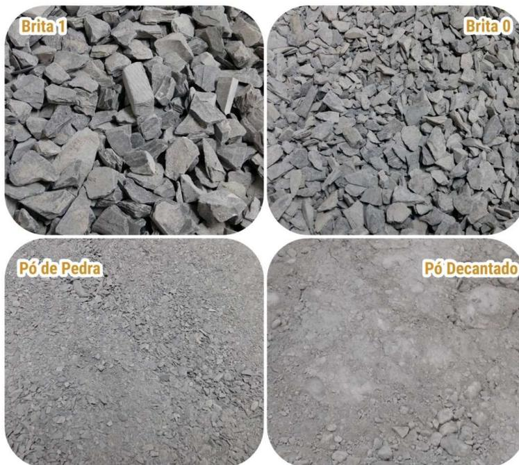
Figura 2: Agregados pétreos utilizados na mistura asfáltica.
