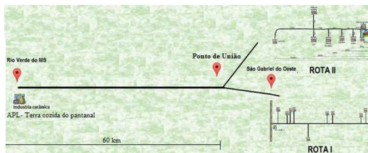
Figura 4: Esquema do biogasoduto, com 60 km, da ROTA III, interligando o Ponto de União (das Rotas I e II) até o APL Terra Cozida do Pantanal, em Rio Verde do MT.
