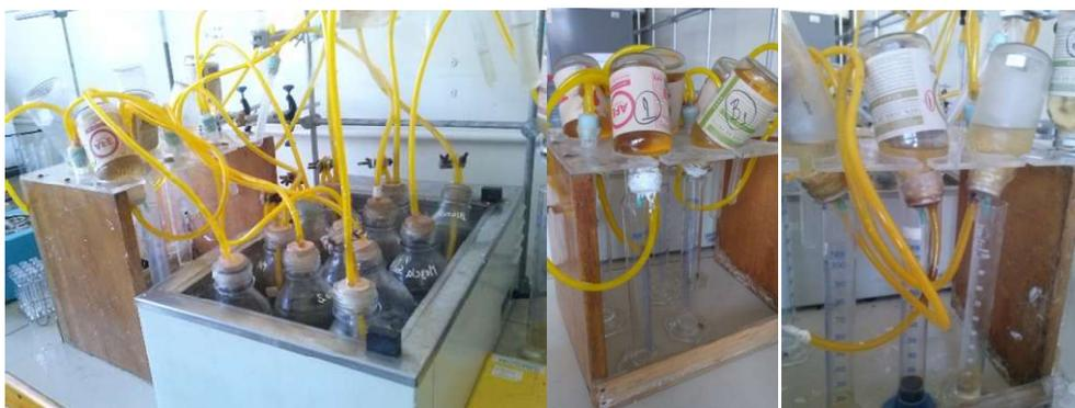
**Figura 2:** Disposição dos minirreatores em banho no ensaio de biodegradabilidade anaeróbica para condições mesofílicas (37°C) e medição de metano através de provetas graduadas.
