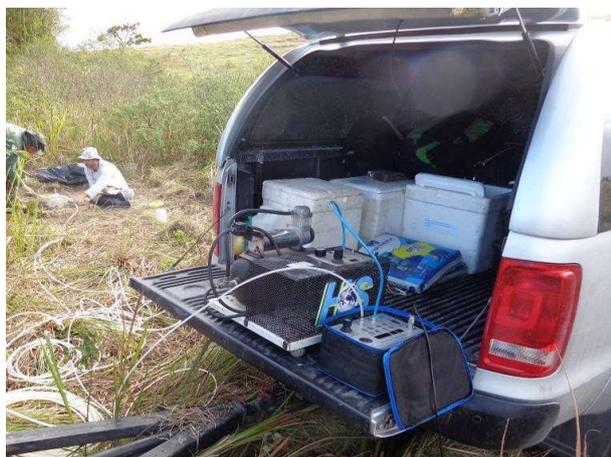
Figure 4: Bomba de control para la recolección de agua subterránea.
