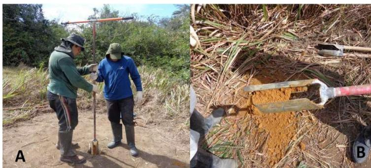
Figure 3: Perforación por trado (A). Suelo perforado.
