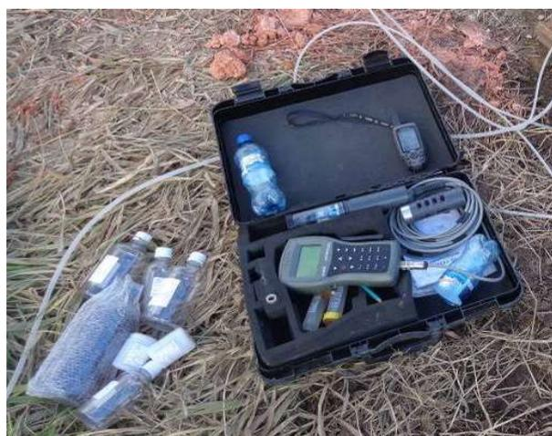
Figure 5: Sonda multiparámetro INS-87 usada para la recolección de agua.
