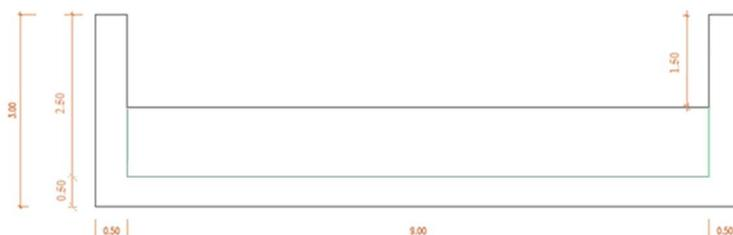
Figura 6: Vista frontal em corte da armadilha de sedimentos após alterações.
