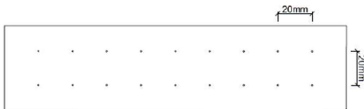
Figura 3: Placas do ensaio de resistência à flexão do conjunto A com espaçamento de 20 x 20 mm.
