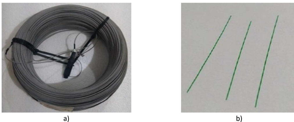
Figura 1: a) Bobina de Cabo de Rede Drop. b) Fibra óptica cortada com estilete
