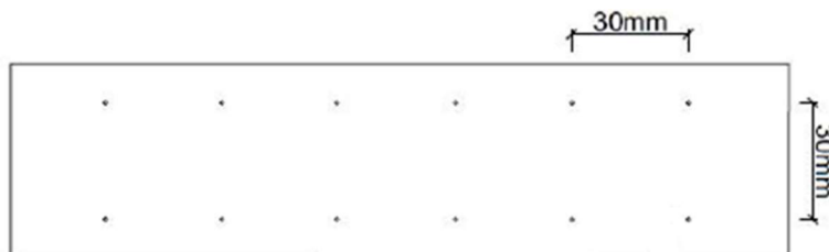
Figura 4: Placas do ensaio de resistência à flexão do conjunto A com espaçamento de 30 x 30 mm.
