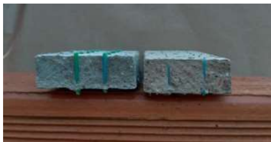
Figura 7: Placas dos conjuntos B e A, respectivamente, após ruptura por ensaio de tração.
