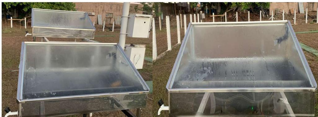
**Figura 3:** Efluente condensado na cobertura do destilador forçado e natural.
