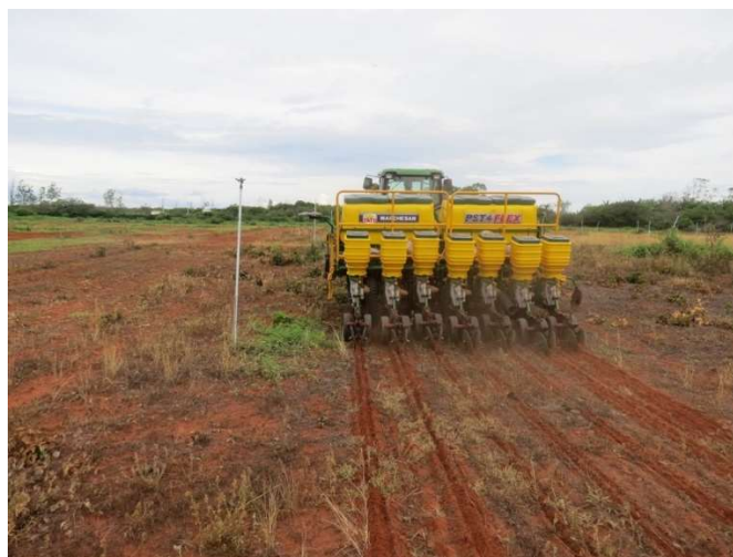
Figura 4: Semeadora-adubadora para realizar semeadura do milho ( Zea Mays ). Fonte: Medeiros (2022).
