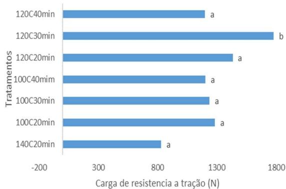
**Figura 3:** Carga de resistência a tração aplicada nos corpos de prova de resíduos de PLA submetidos em diferentes temperaturas e tempo\*.
