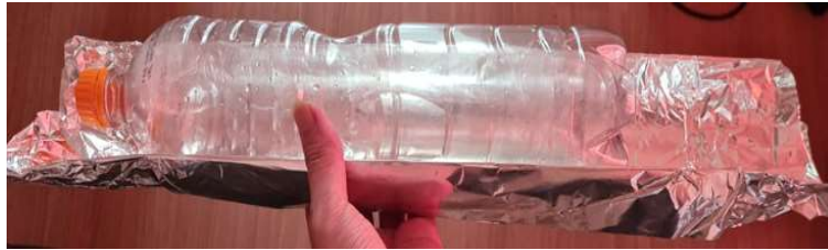
Figura 1: Estrutura SODIS com refletor para favorecer a reflexão dos raios solares no interior do recipiente contendo água bruta.
