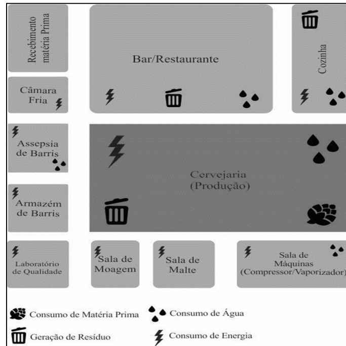
Figura 1: Layout da indústria de cervejas artesanais com os processos de geração de resíduos, consumo de matéria prima, água e energia.
