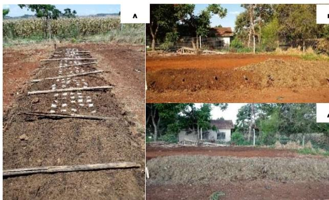
**Figura 4:** Imagens das etapas de montagem da pilha de compostagem. (A) disposição das amostras de EPU sobre uma camada da cama aviária; (B) amostras de EPU cobertas com a cama e parcialmente coberta com a palha; (C) a cama aviária totalmente coberta com a palha.
