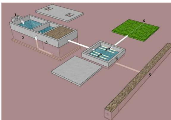
**Figura 2:** Ilustração do sistema compacto de tratamento e uso agrícola e florestal de águas cinzas. **Nota:** 1 - Tanque de equalização; 2 - Tanque séptico; 3 - Filtro anaeróbio; 4 - Reator ultravioleta artificial; 5 - Vala de infiltração; e 6 - Área de reuso agrícola e florestal (6).
