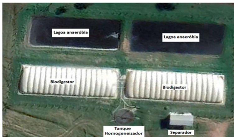
Figura 1: Vista de satélite do sistema de tratamento de efluentes proveniente de ARS. Fonte: Google Earth (2021).
