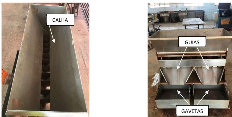
**Figura 1:** Características físicas do Quarteador da marca Dialmática, em que: (a) as calhas responsáveis pela separação das amostras; e (b) as guias por onde passam as amostras; e as gavetas que recebem as amostras já separadas.
