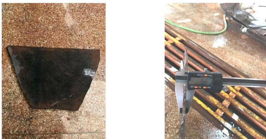
**Figura 2:** Características do material de descarte utilizado como redutor do ruído, em que: (a) formato da borracha que foi adaptada nas guias e gavetas do quarteador; e (b) aferição da espessura do material
