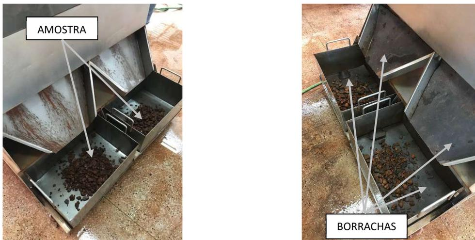
**Figura 4:** Quarteador da marca Dalmática depois da separação das amostras: (a) guias e gavetas do quarteador antes da instalação das borrachas; e (b) guias e gavetas do quarteador depois da instalação das borrachas.
