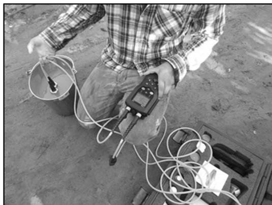
**Figura 4:** Medição dos parâmetros de qualidade da água com a sonda multiparamétrica em uma amostra coletada de um poço do bairro Parque Nova Era.
