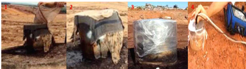
Figura 3: Procedimento para aferição da composição do biogás. Fonte: Adaptado Castro (2016).
