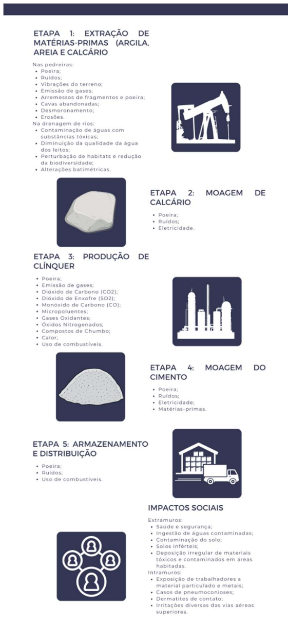
Infográfico 1: Impactos ambientais e sociais do processo de produção da indústria de cimento.
