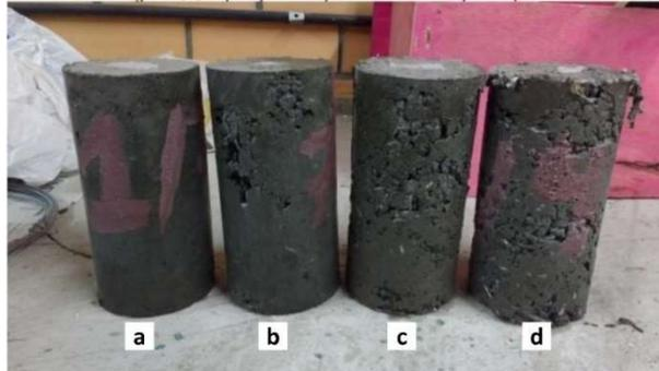
**Figura 3:** Comparação do aspecto visual dos corpos de prova. a) traço controle; b) traço 1; c) traço 2; d) traço 3.
