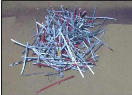
**Figura 1:** Produção das tiras de embalagens cartonadas para aplicação em reforço de concreto.
