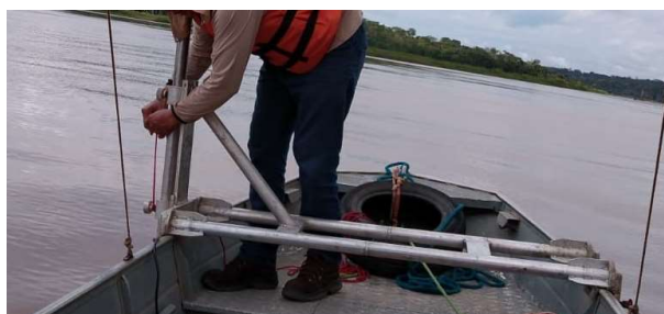
Figura 03: Embarcação equipada com o Sistema SeeSub ® /Venturo acoplado na lateral operando a 50 cm da superfície, utilizado para aquisição de imagens subaquáticas multifrequenciais na catenária do antigo Log Boom da UHE Jirau, Rio Madeira (RO).
