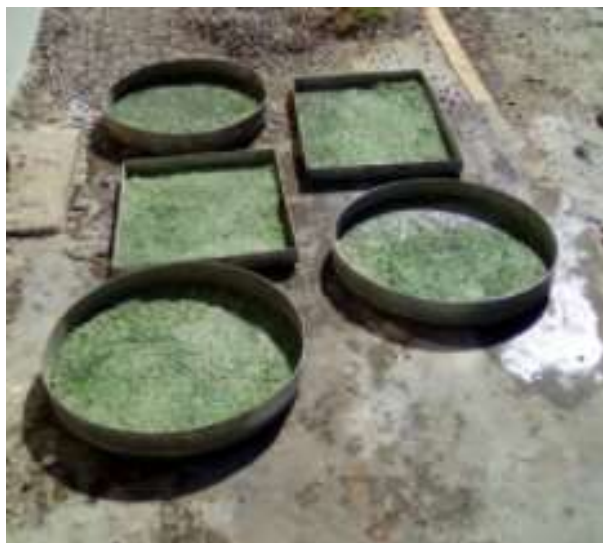
Figura 1 – Secagem do vidro sob ação direta do sol.
