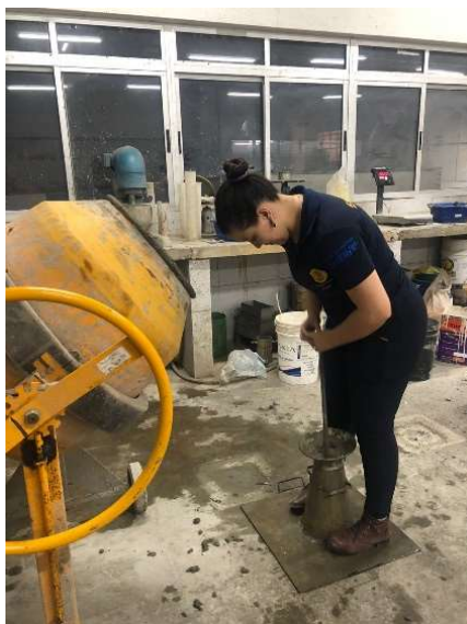
Figura 2: Realização do slump test.
