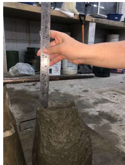
Figura 3: Medição do abatimento do concreto.
