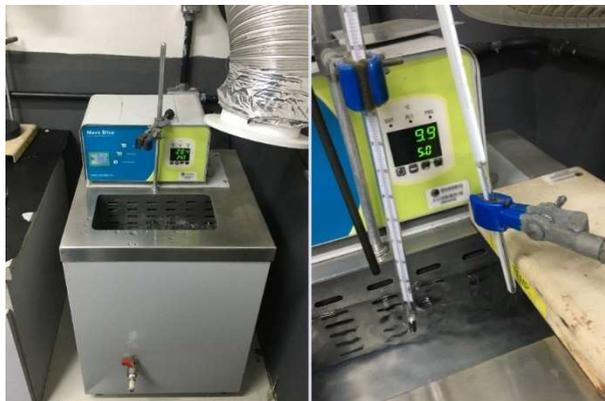
**Figura 2:** Banho ultratermostático sendo utilizado na calibração de um termômetro de líquido em vidro.
