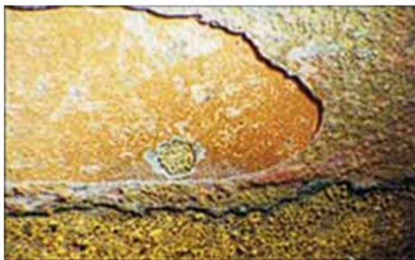
Figura 1: Imagem por microscópio óptico de superfície de tubo de superaquecedor de caldeira de recuperação que teve corrosão acelerada por mecanismo de “oxidação ativa”. Fonte: Mäkipää et al. (2004).
