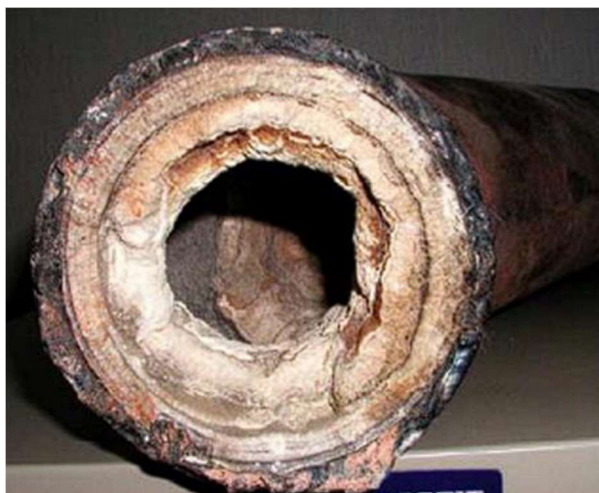
Figura 2: Exemplo de incrustação em tubo. Fonte: Castro (2015).
