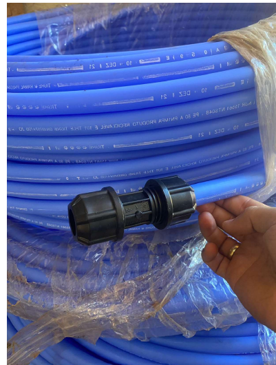
Figura 5: PEAD 20 mm com conexão aplicada.
