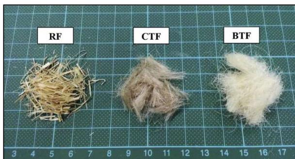
**Figura 6:** Fibras cruas (RF), tratadas quimicamente (CTF) e fibras tratadas biologicamente (BTF). **Fonte:** Iucolano et al. (2018).
