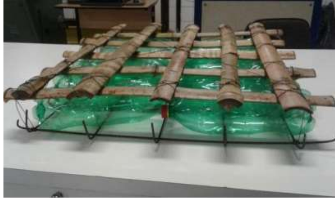
Figura 4: Armação de laje com aço, bambu e garrafa PET. Fonte: Silveira (2019).
