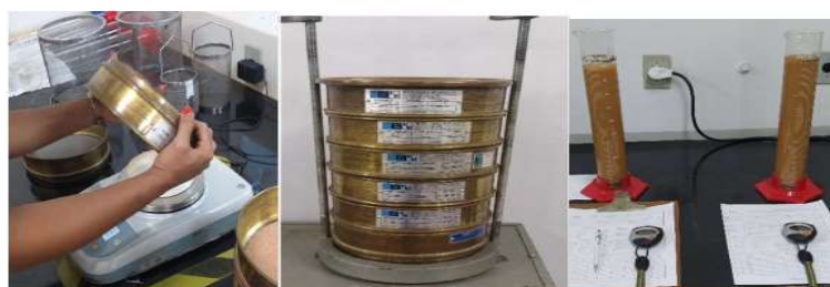
Figura 3: Procedimentos para o teste granulométrico. Fonte: Godinho et al. (2020).
