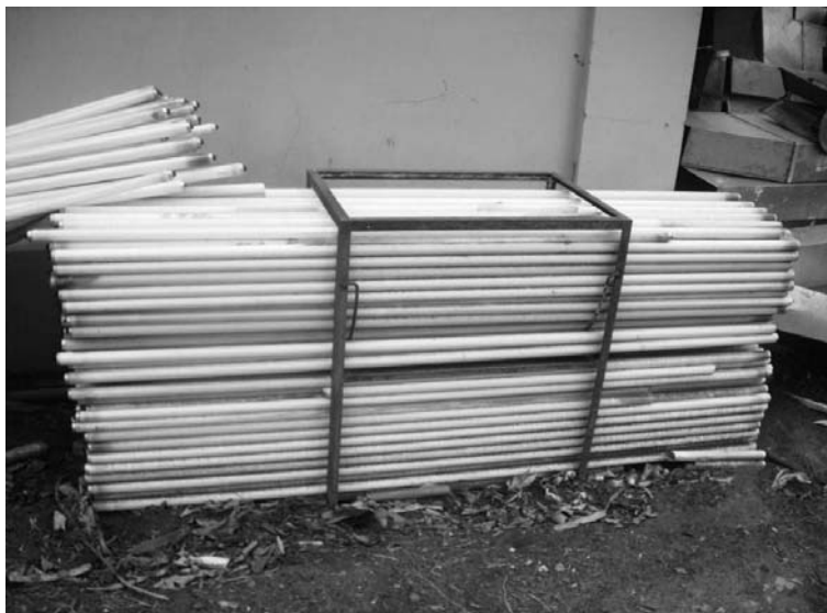
Figura 1: Armazenamento inadequado de lâmpadas fluorescentes no campus universitário.
