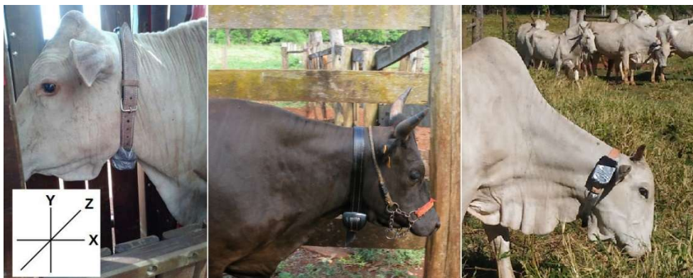
Figura 2: Diferentes posicionamentos que o colar pode assumir em relação ao pescoço do animal. Destaque para as posições dos eixos do sensor acelerômetro.
