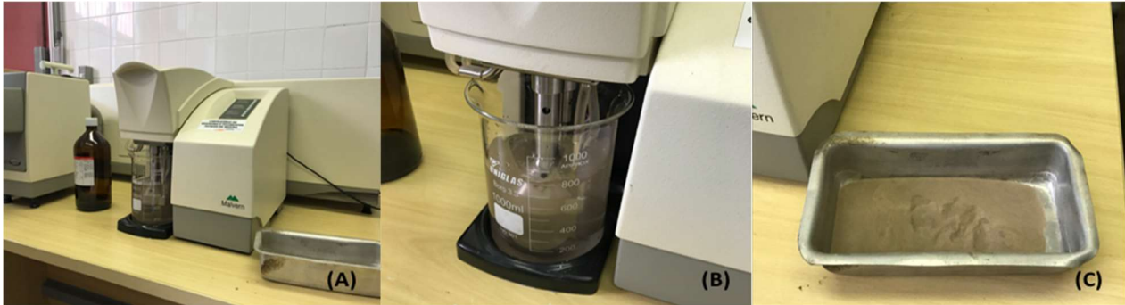
Figura 2: Equipamento Malvern Mastersizer 2000 (a), ensaio em andamento (b) e amostra seca (c).
