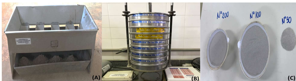
Figura 1: Quarteador amostral (a), conjunto de peneiras (b) e amostra após peneiramento (c).
