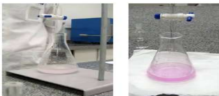
Figura 3: Análise titrimétrica do índice de acidez de uma amostra de biodiesel.
