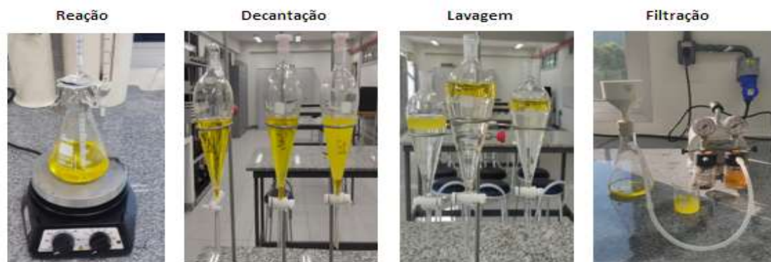
Figura 2: Descrição visual das etapas de síntese de biodiesel metílico em escala de bancada.
