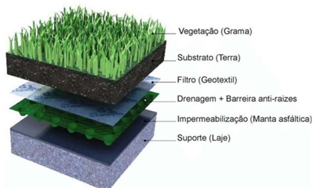
Figura 4: Estrutura de um telhado verde<sup>1</sup>.
