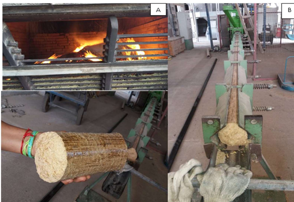
Figura 2: Utilização das cascas pelas beneficiadoras locais. (A) cascas utilizadas in natura nas fornalhas. (B) máquina de fabricar briquete. (C) briquete.
